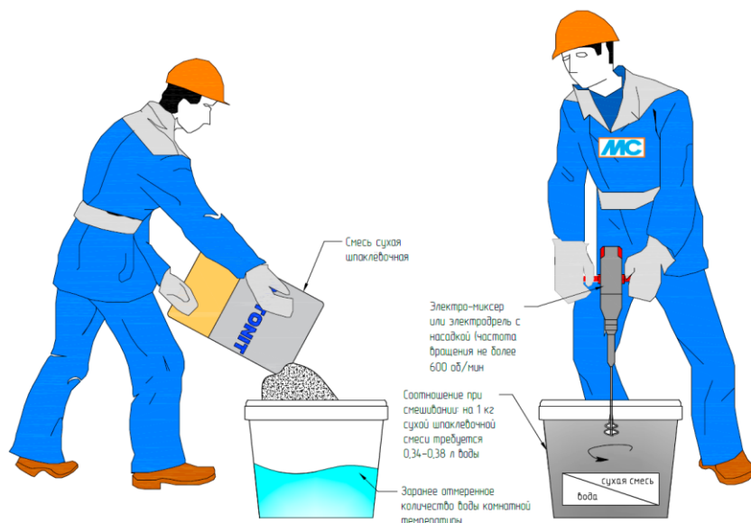
Рис. 22. Организация работ по затворению сухой шпаклевочной смеси
